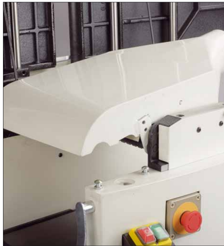
Im Betrieb als Dickenhobel deckt der Ansaugstutzen die Messer und die Transportwelle ab
