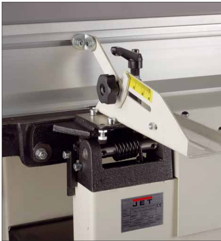
Der Werkstück-Anschlag kann, durch zwei Schrauben gesichert, zwischen 0° und 45° gekippt werden. Die beiden anderen Knebelschrauben dienen der Positionierung des Anschlags auf dem Abrichttisch
