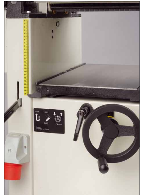
Die Durchlasshöhe der Dicke wird mit der Kurbel eingestellt und mit dem Hebel fixiert
