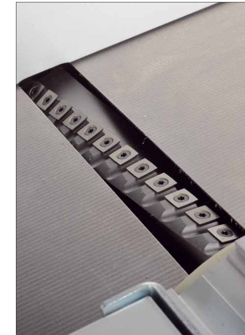
Die Hobelmesser dieser Maschine sind etwas Besonderes. Anstelle durchgehender Messer verfügt die Hobelwelle über vier Messerreihen, die jeweils aus 14 Wendemessern bestehen
