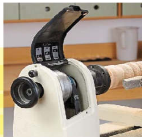
Zusätzlich kann die Rippenriemen-Übersetzung leicht dreifach verstellt werden – werkzeuglos!
