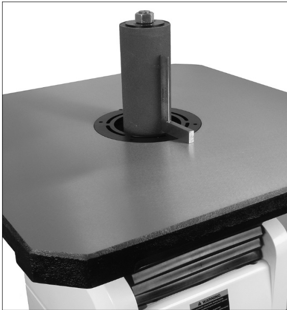
Abbildung 13: Einstellen des Neigungsanschlags
